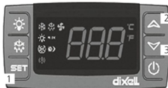
Fig. 3 Tipo de regulador DIXELL Elementos de operação e indicações no visor (apresentação de símbolos)
