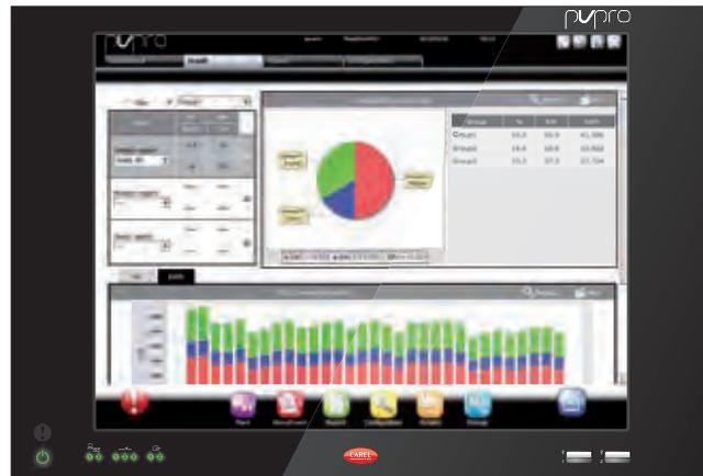
*Floating Suction Pressure Control: Für Retail-Anlagen mit CAREL-Steuerungen und PlantVisorPRO kann der Energieverbrauch der Anlagen anhand des Funktionsalgorithmus der Regelung des frei schwankenden Saugdrucks optimiert werden. Das CAREL-System garantiert die Energieeinsparung durch die Anpassung des Sollwertes der Verbundkälteanlagen an die Parameter der Feldgeräte. Realinstallationen mit diesem Feldalgorithmus bestätigen Einsparungsquoten über 15%.*
